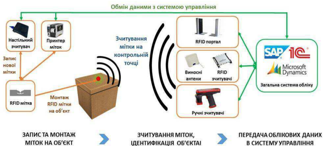
Рисунок 1 - Структурна схема RFID-системи та технічне устаткування
