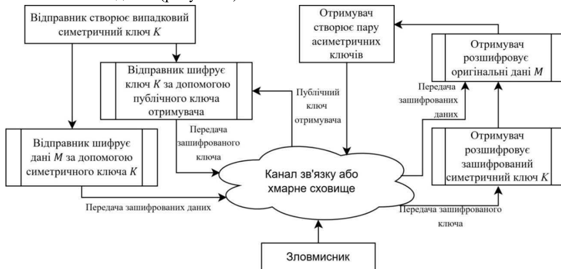
Рисунок 3 - Загальна схема гібридного шифрування
