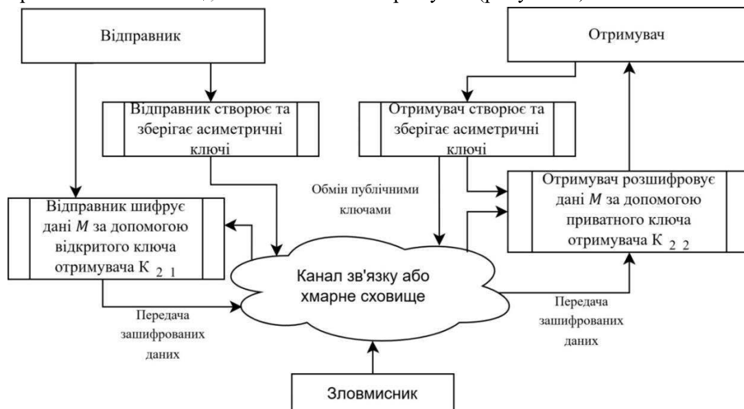
Рисунок 2 - Схема асиметричного шифрування
